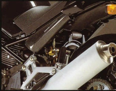
La suspension arrière progressive est dotée d'un mono amortisseur réglable Öhlins.
