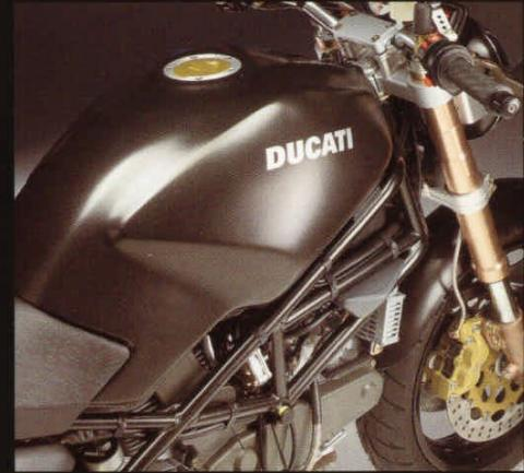
Les Monster 750 et 900 sont équipées d'un radiateur d'huile moteur additionnel et d'un double disque avant flottant ø 320 mm à commande hydraulique. Ce freinage très puissant réduit très sensiblement les distances d'arrêt.
