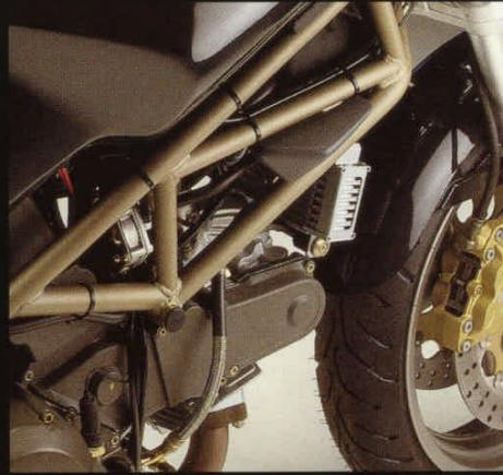
Les Monster 750 et 900 sont dotées de frein avant double disque à commande hydraulique et d'un radiateur d'huile moteur additionnel.
