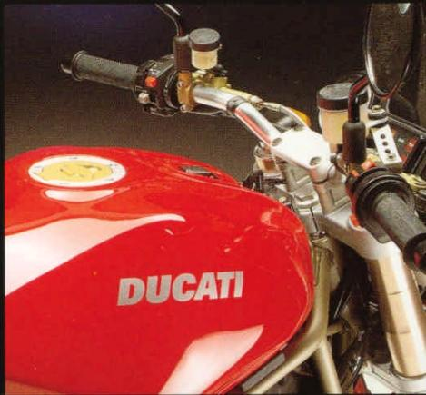
La Monster 900 est équipée de maîtres-cylindres de freins et d'embrayage à réservoir séparé et levier réglable.
