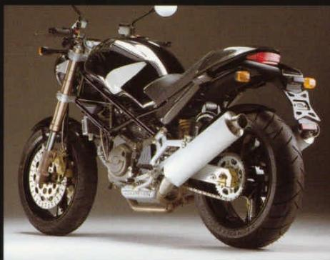
Dosseret arrière et garde-boue avant en fibre de carbone.
