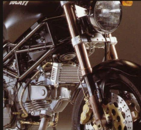
Sur les modèles 900 Dark et 900 CityDark, la fourche de marque Showa est de type inversé. Elle offre de multiples réglages et est équipée de solides tubes ø 41 mm.
