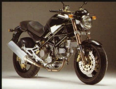
La suspension avant repose sur une fourche inversée, Ø 41 mm, réglable en détente, compression et précharge ressort.
